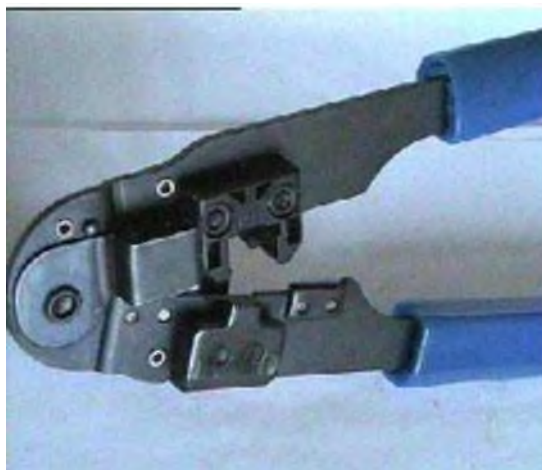
Устройство для зачистки и обжима витых пар
